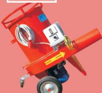
**TOMASSER® RB** je stacionarna seckalica na električni pogon, namenjena za sekanje okruglih i velikih pravougaonih bala. Zahvaljujući visokoj produktivnosti, ova mašina je idealna za profesionalnu i industrijsku upotrebu. **TOMASSER® RB** savršeno radi u paru sa linijom za briketiranje **Biomasser® MULTI** ili **MOBILE**.
